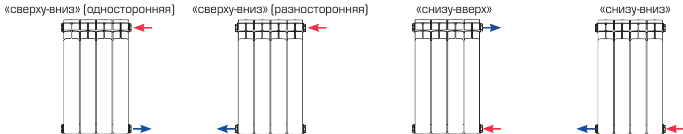
Рис. 5. Возможные схемы нижнего подключения (O120/O121) радиаторов STOUT Bravo к трубопроводам системы отопления:
